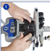
1 Schuif en til de toegangsdeur open
