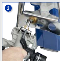
Gebruik de zeskantfitting voor het frame om de pomp los te maken en de pomp te verwijderen
